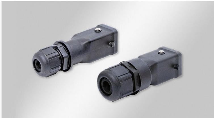
Ensemble d'inserts 3A ou 4A et capots de connecteurs correspondants avec presse-étoupes M20 (diamètre de câble 6 - 12 mm) ou M25 (diamètre de câble 13 - 18 mm) intégrés pour joints d'adaptation AT-HA et cadres passe-câbles divisibles MIS.
